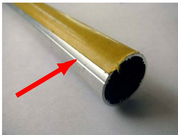
Рис. Наклеивание клейкой ленты на трубу
