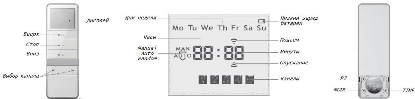
Пульт DD1805H служит для управления приводами Amigo как обычными, так и с обратной связью. Использование режима с обратной связью даёт ряд дополнительных преимуществ, таких как повышенная помехоустойчивость и быстрый отклик на команду из-за улучшенной кодировки сигнала.
