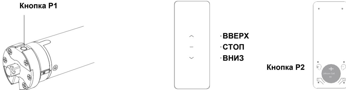
**Из-за особенностей работы привода со встроенным аккумулятором все настройки должны производиться с радиопередатчика/канала, индивидуального для данного привода. В противном случае изменения настроек могут затронуть другие приводы, запрограммированные на данном радиопередатчике/канале**
