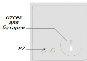
Кнопка настройки «P2» и отсек для батареи
