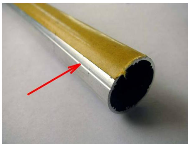
Рис. Наклеивание клейкой ленты на трубу
