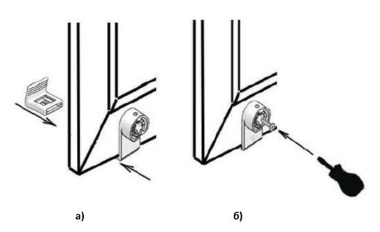
4.3. Вставить крышку в кронштейн, леска должна проходить через 2 паза к кронштейне. Крутить по часовой стрелке для натягивания лески. Остатки лески отрезать.
