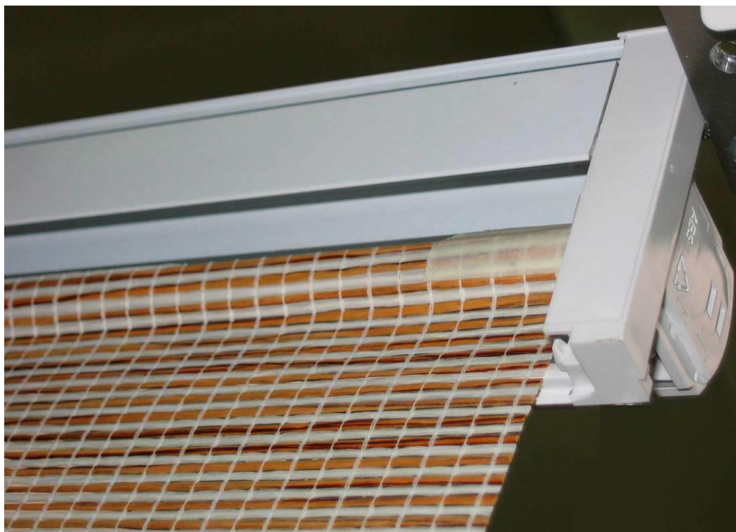
Рис. Выравнивание ткани путем наклеивания скотча Высота готового изделия измеряется при помощи рулетки.
