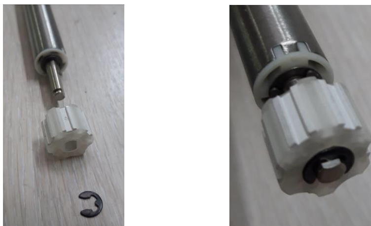
Рис. Установка адаптера на мотор
