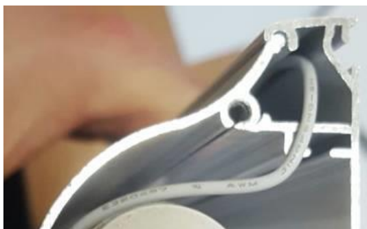
Рис. Установка трубы с мотором в изделие.
